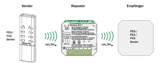
Alle Funksender der Geräteserien FS3 und FV2 sind mit dem Funk-Repeater FV2 R kompatibel Alle Funkempfänger der Geräteserien FE3, FD3 und FV2 sind mit dem Funk-Repeater FV2 R kompatibel
